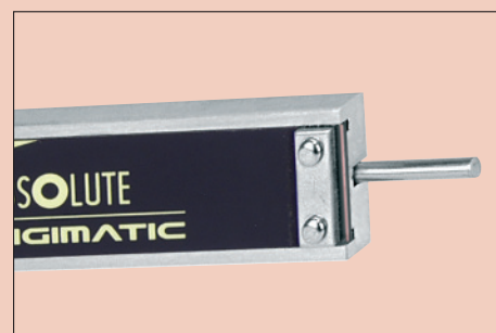
500-150-20 en 500-158-20 met ronde dieptemaat Ø 1,9 mm voor kleine boringen
