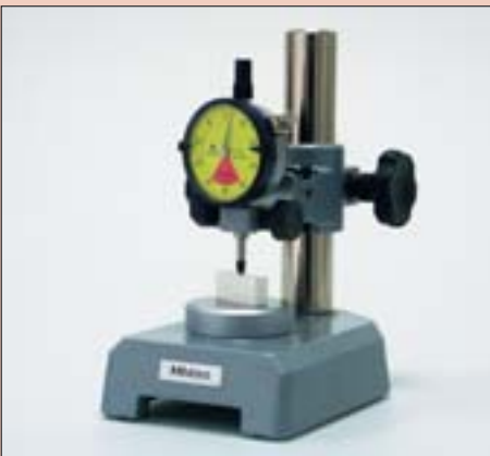
Artikelnr. 2929 SB in meetstatief artikelnr. 7002 M
